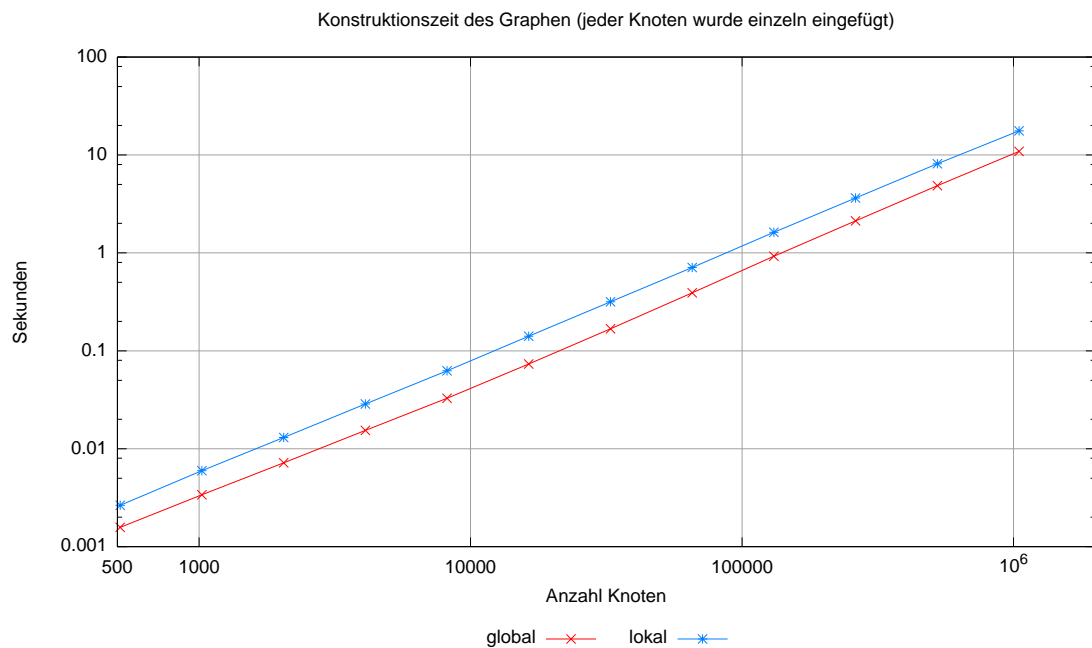
Abbildung 23: Vergleich der Konstruktionszeiten zwischen global und lokal gesetztem Protect_FPU_rounding .
